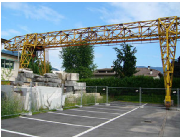
Rys. 1. Suwnica bramowa o konstrukcji kratownicowej
