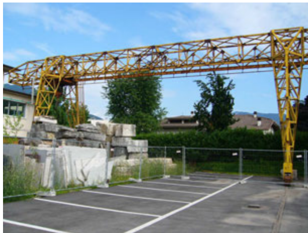
Rys. 1. Suwnica bramowa o konstrukcji kratownicowej
