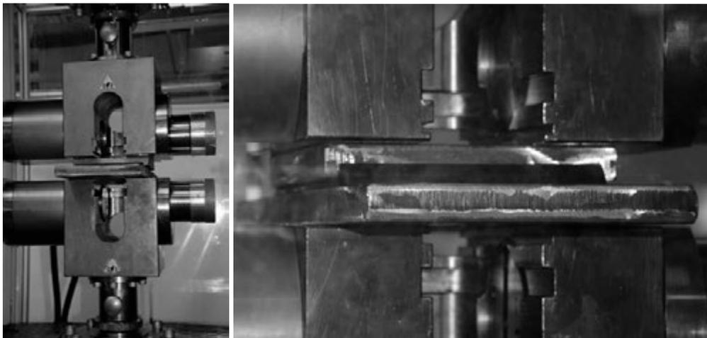
Рис. 1. Испытания подрельсовых прокладок на прессе Zwick Z250
