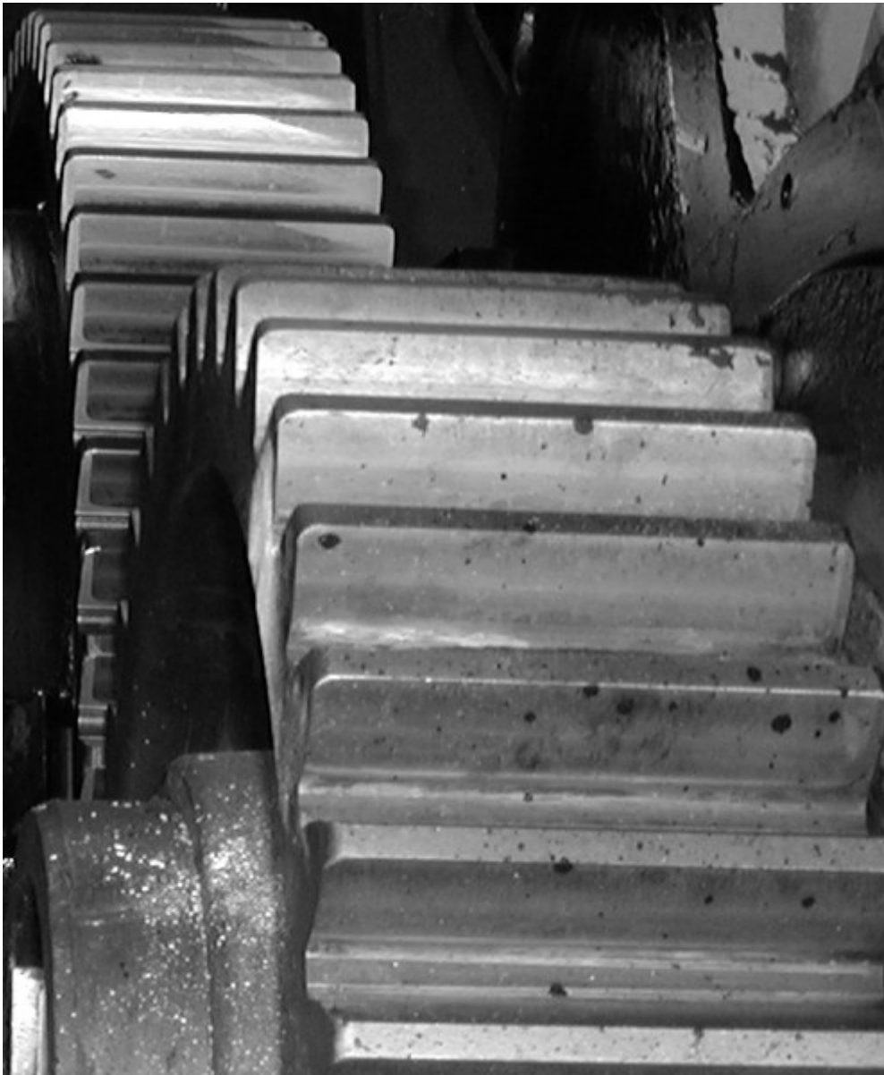
Рис. 3. Износ зубьев тяговой передачи локомотива
