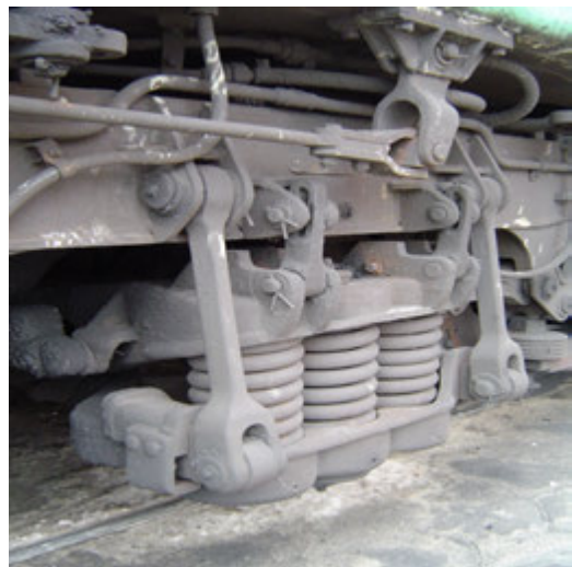
Rys. 6. Widok uproszczonego połączenia ramy wózka z belką bujakową wraz z widokiem rzeczywistym
