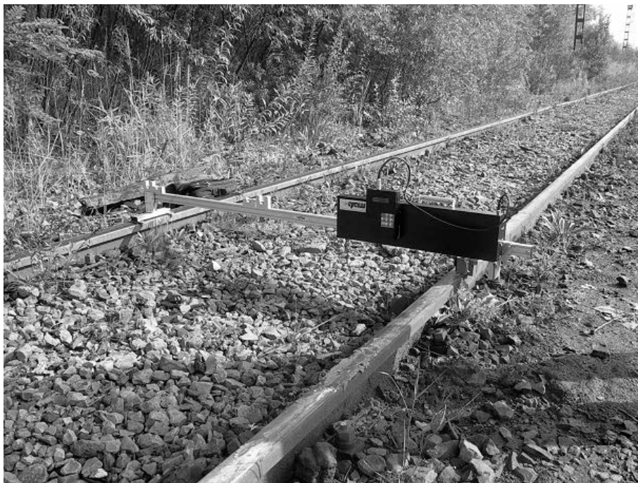
Рис. 8.9. Сканирование профиля рельсов при помощи лазерного профилографа типа РХУ
