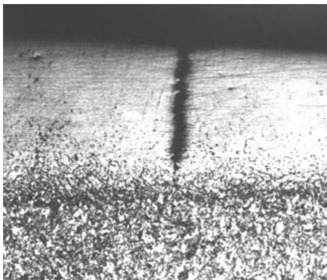
Рис. 5.20. Образование трещин в зоне «белого слоя»; x200
