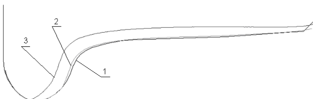
Рис. 8.8. Процесс изнашивания поверхности катания с исходным профилем 28UIC140 электровоза EU07
