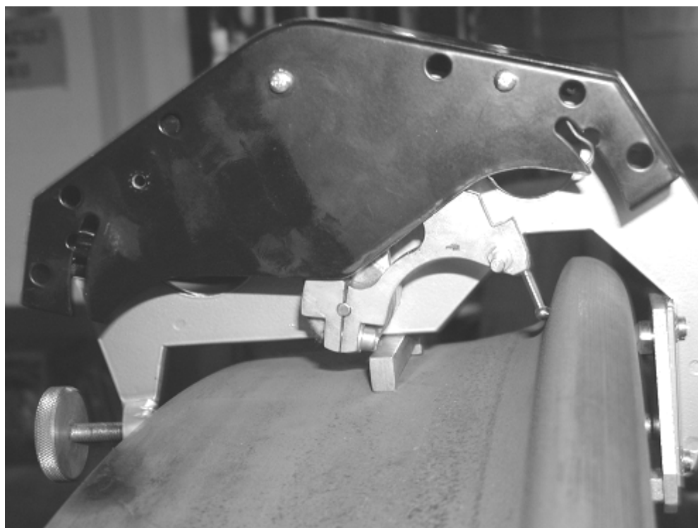
Рис. 8.7. Сканирование профиля колеса в лабораторных условиях при помощи лазерного профилографа типа А-В
