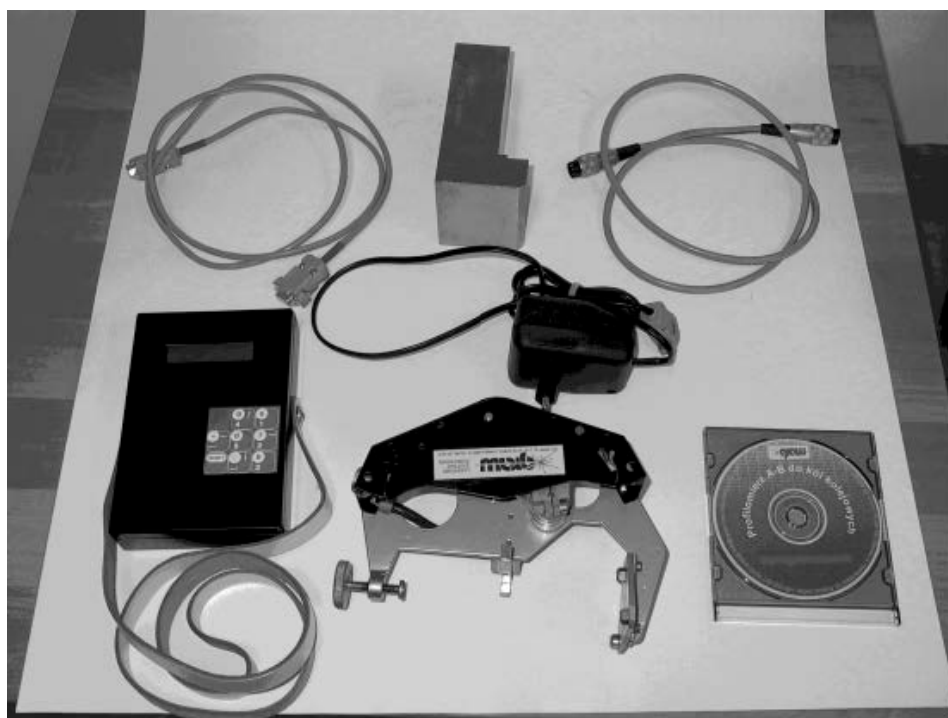
Рис. 8.6. Комплектация лазерного профилографа типа А-В
