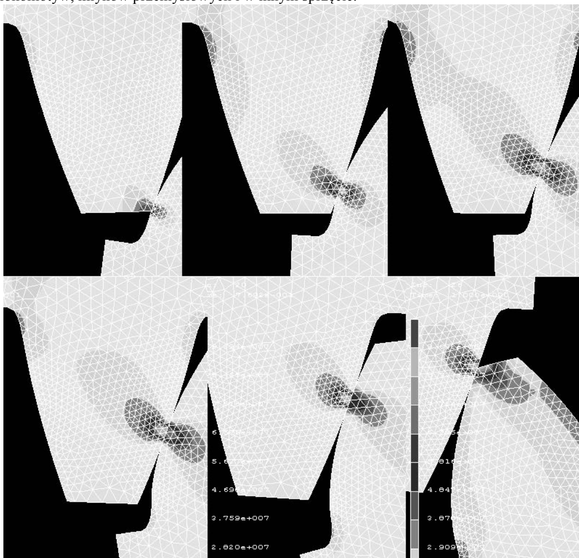
Rys. 3. Przykład otrzymanego stanu naprężeń zębów przekładni napędowej lokomotywy EU07 z wykorzystaniem proponowanej metodyki modelowania
