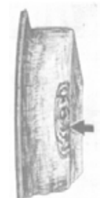
Рис. 1. ж. Поверхностный откол обода
