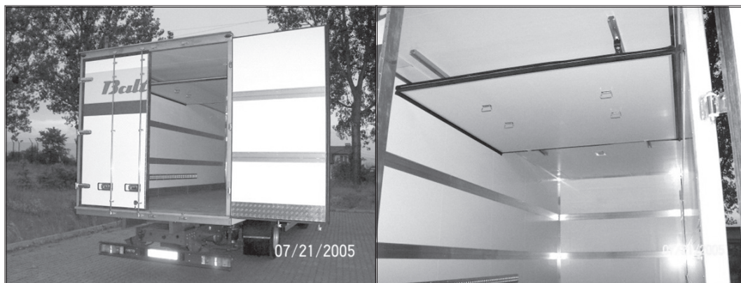
Рис. 3. Кузов-рефрижератор с перемещающейся внутренней стенкой-перемычкой для автомобиля IVECO EuroCargo 150E24
