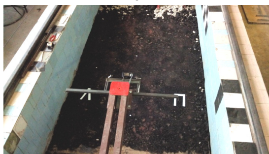
Рис. 2. Этапы проведения эксперимента: a – подготовка площадки и выравнивание щебня; б – укладка холодной асфальтовой крошки и ее уплотнение катком; в – установка на державку фотоаппарата и камеры; г – съемка поверхности в статике и в движении
