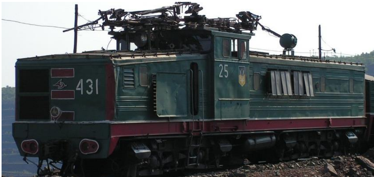
Рис. 4. Тяговый агрегат постоянного тока двойного питания ПЭ2М
