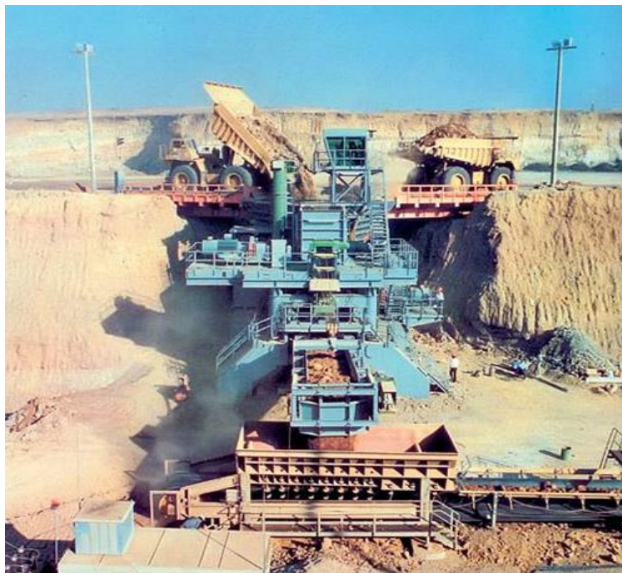
Рис. 1. Стационарный ДПП с двумя точками разгрузки
