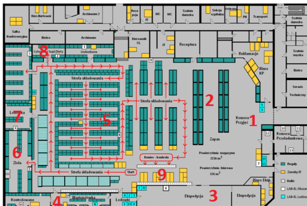
Рис. 1. Схема склада: 1. Зона приемки; 2. Зона инвентаризации; 3. Экспедиция; 4. Зона хранения продуктов, подлежащих специальному учету; 5. Основная зона хранения; 6. Хранение трав; 7. Хранение термолabileльных продуктов; 8. Хранение цитостатиков и БАД; 9. Зона контроля
