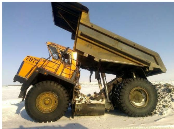
**Рис. 1.** Последствия поломки продольных лонжеронов рамы самосвала
