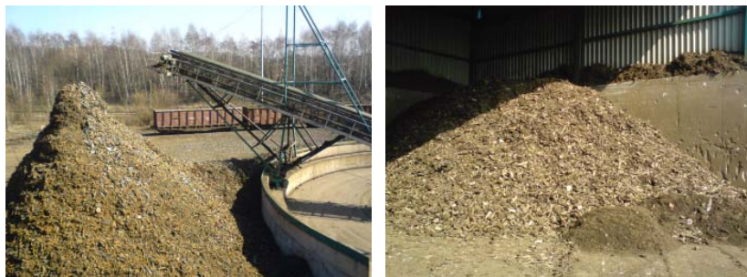
Рис. 7. Складирование отходов в буртах на внешнем складе и закрытых складских помещениях
