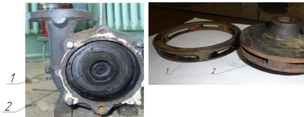
Рис. 4. Конструкция центробежного насоса с соосным расположением рабочих колес: 1 - внешнее рабочее колесо, 2 - внутреннее рабочее колесо
