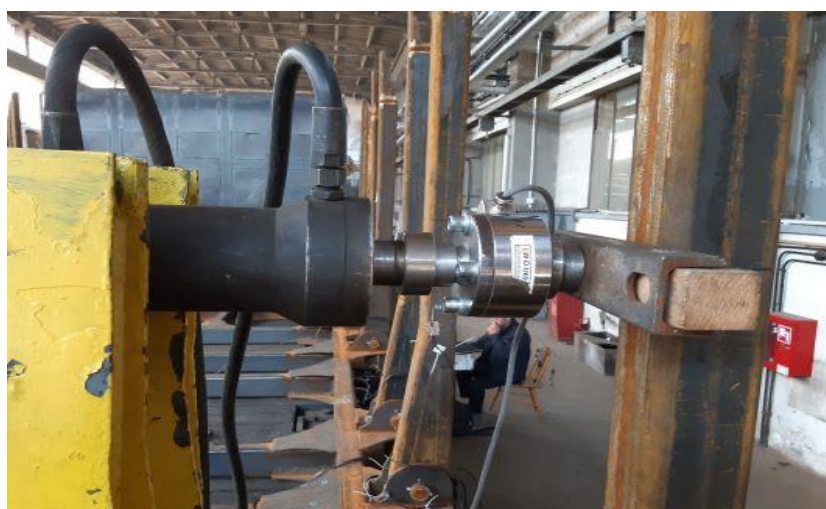
Rys. 13. Stanowisko do pomiaru siły i naprężeń kłonicy
