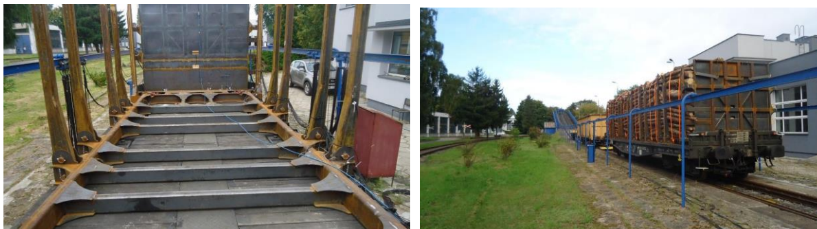
Rys. 10. Wagon i kosz kłonicowy na platformie Rgmms, a) zamontowana instalacja tensometrów, b) wagon z koszami na stanowisku badawczym
