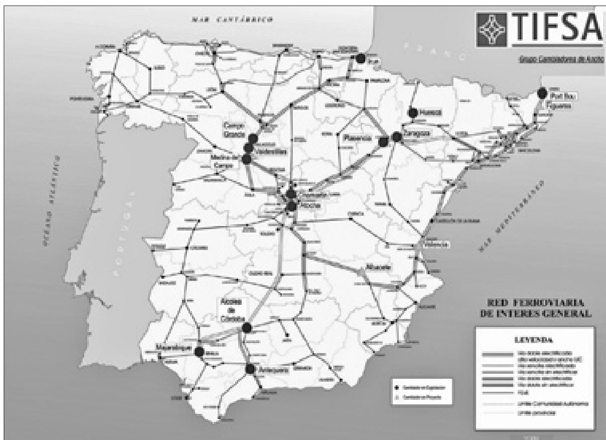
Рис. 6. Ширина колеи железных дорог в Испании и пункты перехода между колеями
