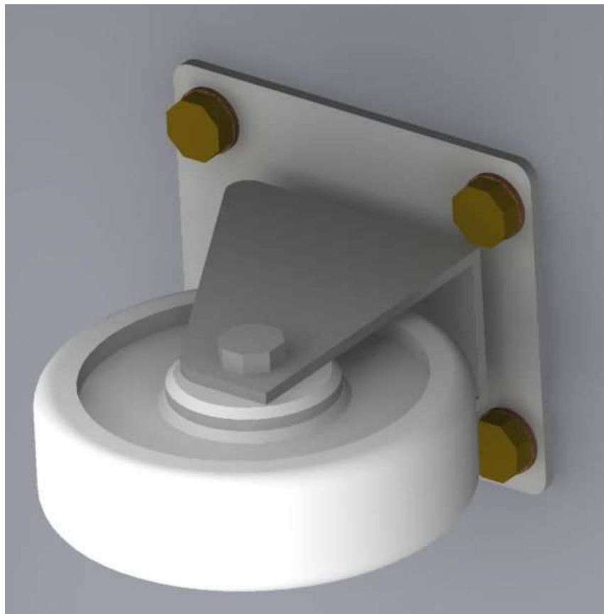
Rys. 5. Mocowanie zestawu kołowego do palety technologicznej
