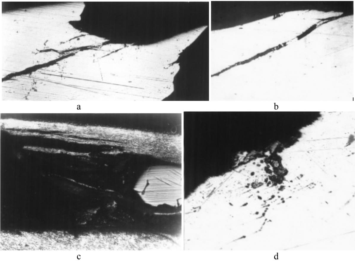
Fig. 2. Cracks (a-c) and corrosion destruction (d) in a flat zone; x100
